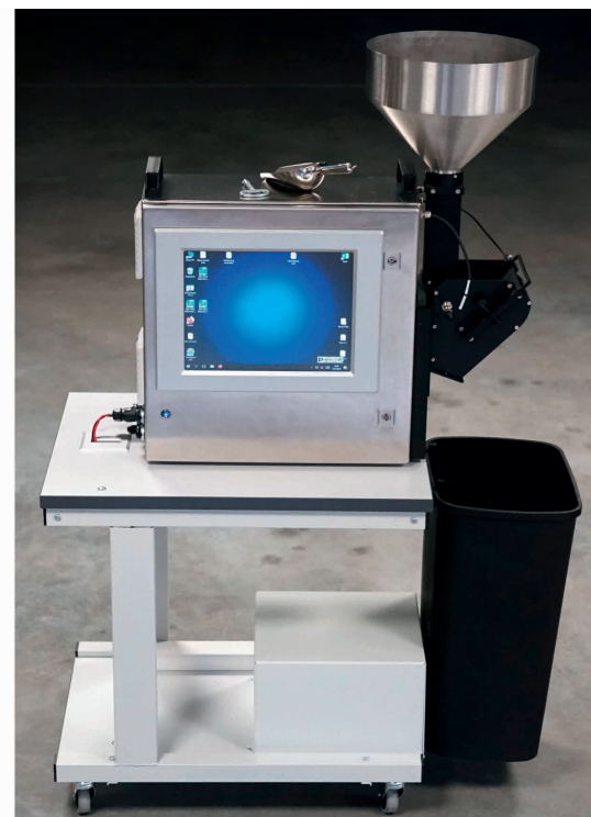
Bild 4. Die beiden Labormessgeräte Spectro-T-3-DIF/0°-Lab-CMU und Spectro-T-3-DIF/0°-Mobile-P beruhen auf der gleichen Technik und eignen sich auch zur Kalibrierung der Inline-Sensoren.
